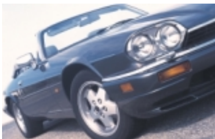
Los parachoques son piezas externas colocadas en la parte delantera y trasera de los coches con el fin de amortiguar los golpes.
