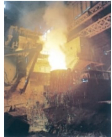
La fundición comienza con la fusión, fase que se lleva a cabo en hornos como el que aparece en la imagen.
