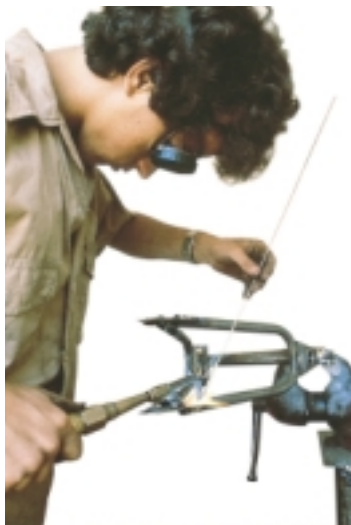
Soldadura de metales.
