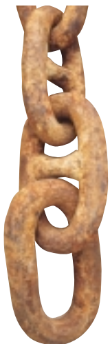
Eslabones de una cadena afectados por corrosión.
