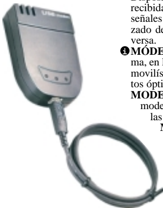
El módem transforma las señales analógicas en digitales y viceversa.
