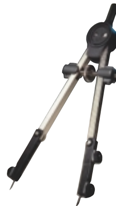
El compás se utiliza para el trazado de líneas curvas.
