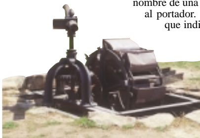
Noria utilizada para la extracción de agua.
